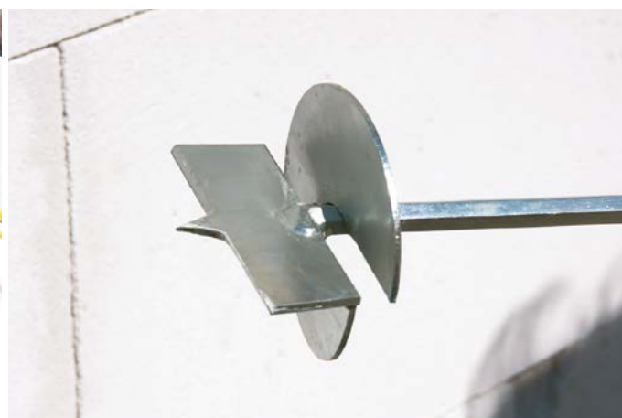
Na vytvoření kapsy použijeme plochý vrták.
